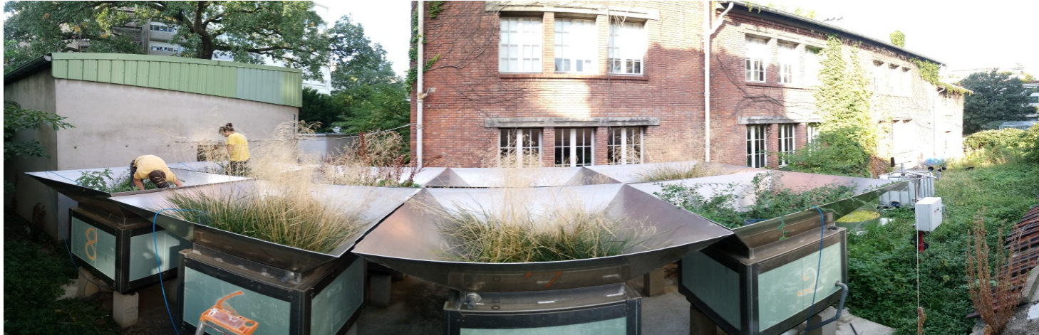
4 surfaces de ruissellement pour une surface d'infiltration = Ratio de 4
